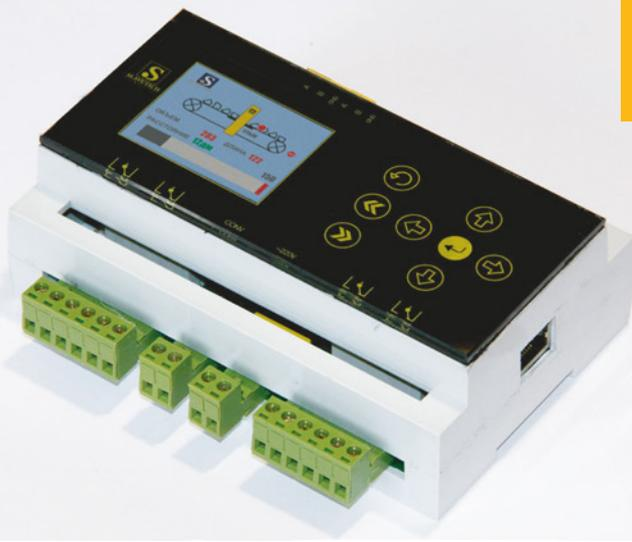
Модуль ЗВ307Е оснащен цветным LCD дисплеем и сенсорной клавиатурой.
